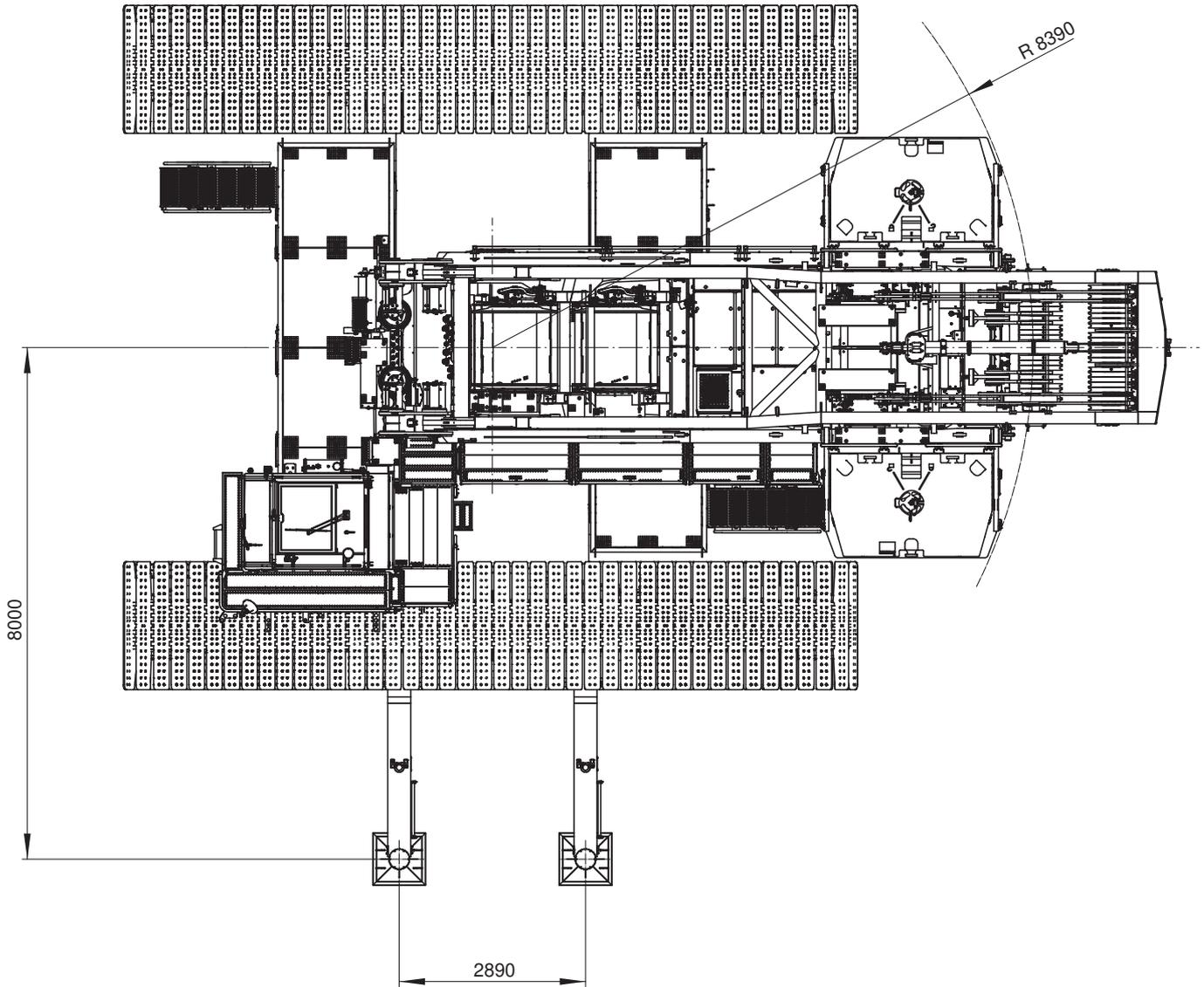
Der Kran ist mit einer Schnell-Verbindung (Quick-Connection QC) ausgerüstet. Dadurch lassen sich Ober- und Unterwagen für den Transport schnell voneinander trennen.
