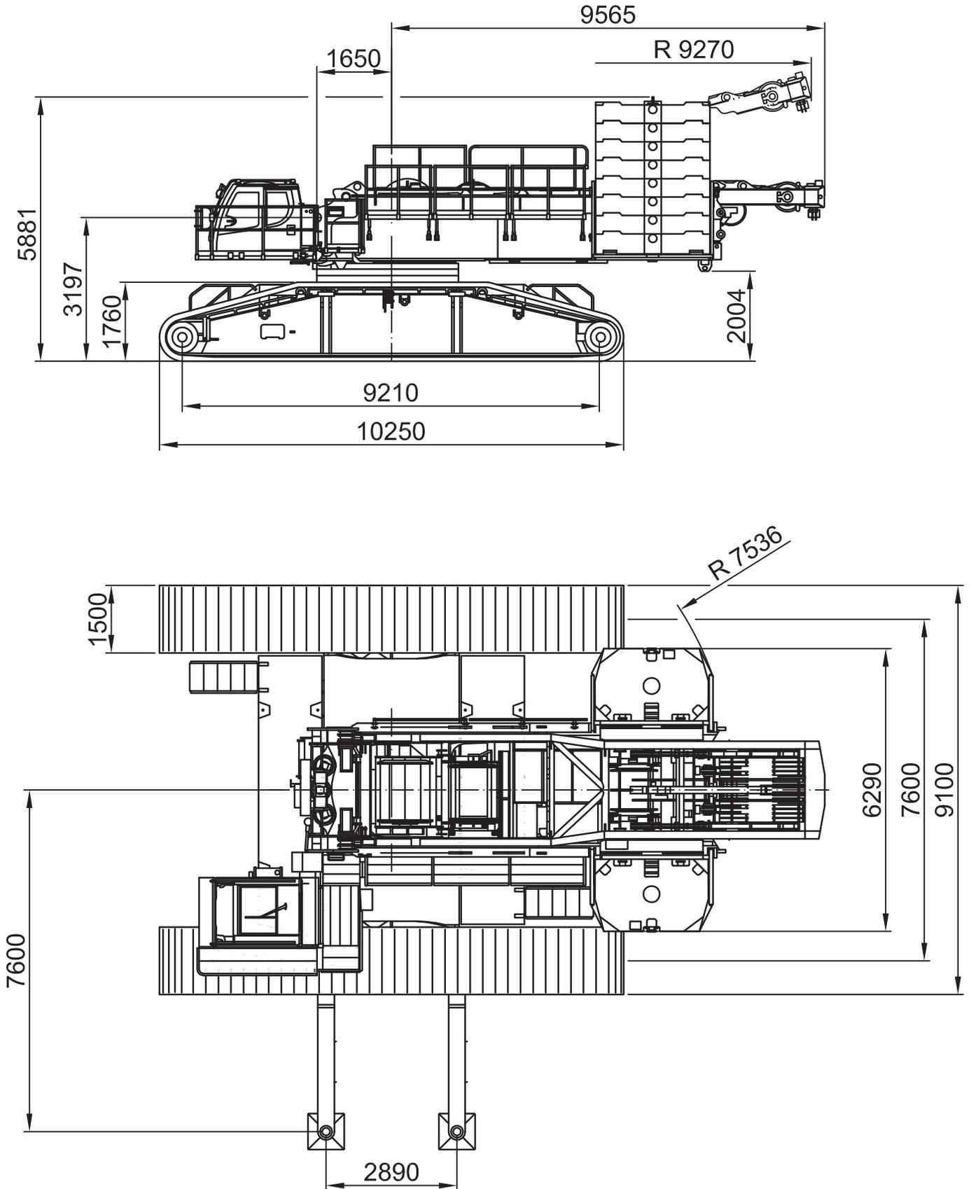
Der Kran ist mit einer Schnell-Verbindung (Quick-Connection QC) ausgerüstet. Dadurch lassen sich Ober- und Unterwagen für den Transport schnell voneinander trennen. Das Transportgewicht der schwersten Einzelkomponente kann damit auf 30 Tonnen reduziert werden.
